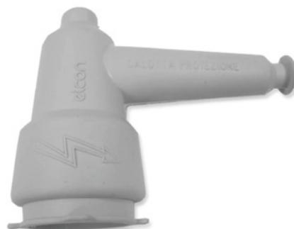
Tubo isolante per la copertura delle connessioni ai passanti e dei colli morti degli ammassi delle linee MT. Realizzato in gomma siliconica resistente agli agenti atmosferici e ai raggi UV.
